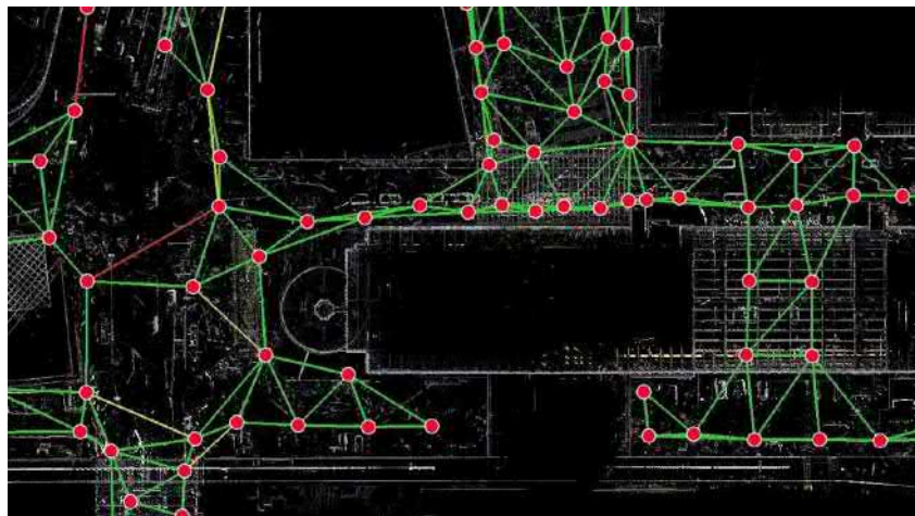
Slika 4. Primjer analize stajališta i potpunosti podataka laserskog skeniranja u LeicaCyclone softveru
