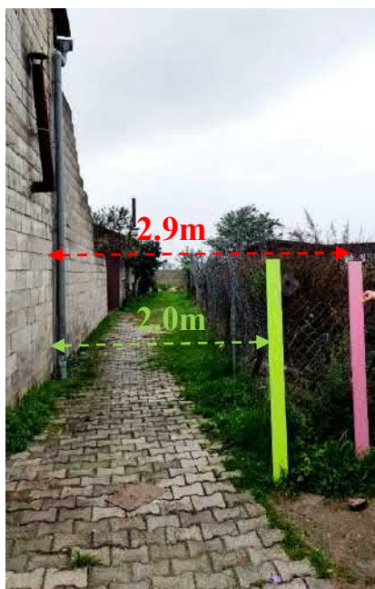
Slika 6. Primjer razlika u položaju iz usporedbe koordinata dobivenih tahimetrijom (crvena) i vektorizacijom (zeleno).
