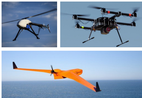
Slika 3. UAV s jednim rotorom (1), multirotor (2), letjelica s fiksnim krilom (3)
