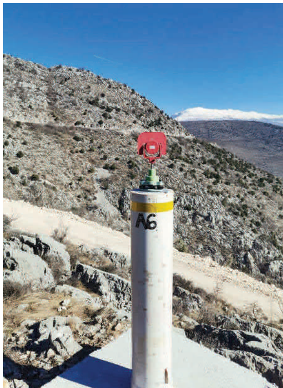
Slika 5. Postavljena prizma na stupu A6
