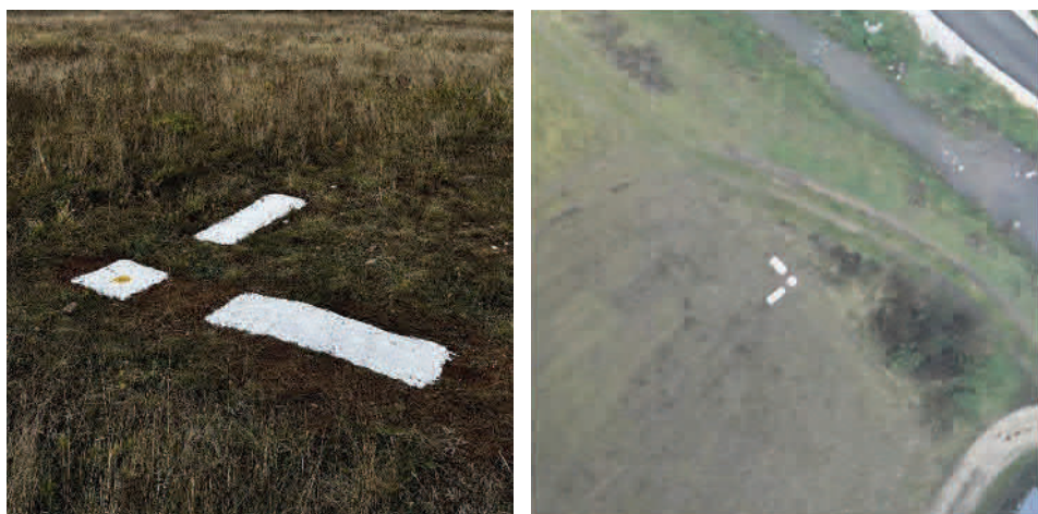
Slika 3. Način fotosignalisanja orijentacione tačke
