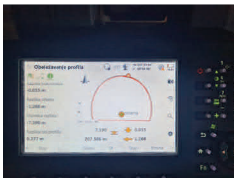
Slika 16. Prikaz iz tunelskoga programa za totalnu stanicu
