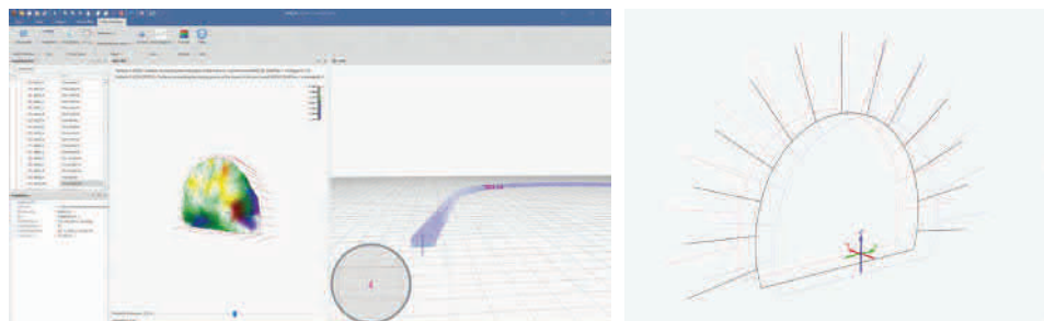
Slika 8. Izrada sheme bušenja tunela i sheme bušenja sidara u programu iSure
