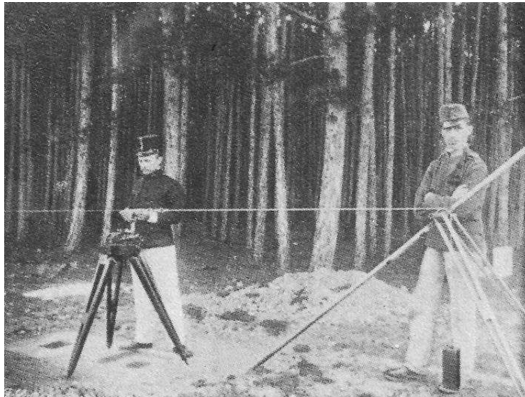
Slika 5: Mjerenje bazisne linije invarnim žicama (Messner, 1980.)
